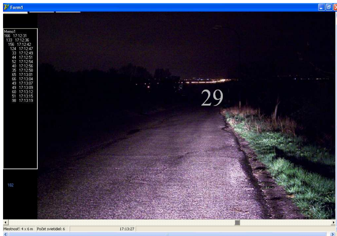
Obr.4: Merací program pre skúmanie vplyvu oslnenia na viditeľnosť prekážky v doprave
