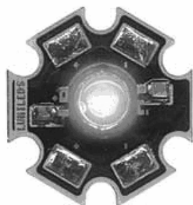
Obr. 1 Výkonová dioda Luxeon III White star a její parametry
