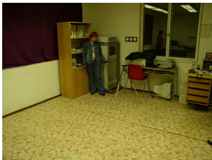
• Obrázek 2: Měřená kancelář – měření ve srovnávací rovině 0,85 m
