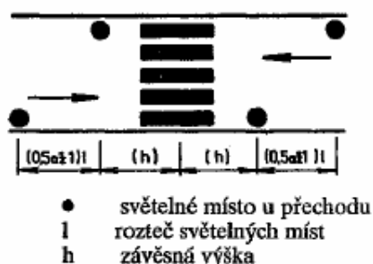
Obr. 10. Osvětlení přechodu s negativním kontrastem
